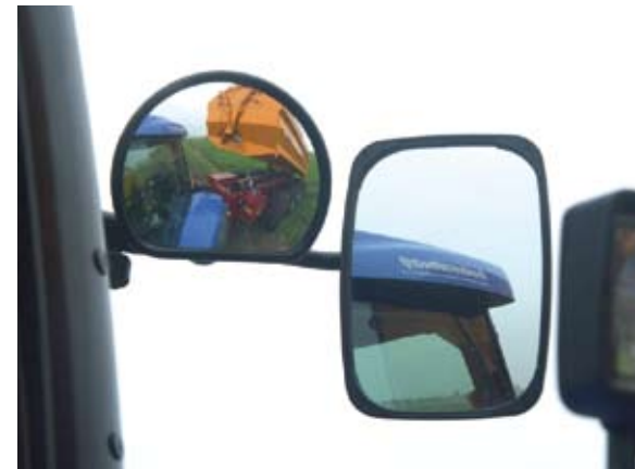
Veiligheid vindt Dunnink belangrijk. Naast twee camera's (achteruitrij en boven op de bak) heeft hij deze handige dodehoekspiegels aangebracht.
