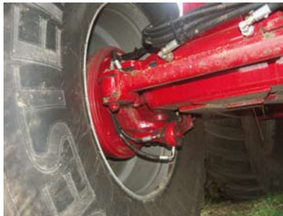
Dunnink heeft zijn eigen wensen verwerkt in de machine, zoals hier het automatisch smeersysteem, uitgevoerd met degelijke hydrauliekleidingen. Het waterpas zetten wordt met de trekkerhydrauliek geregeld.
