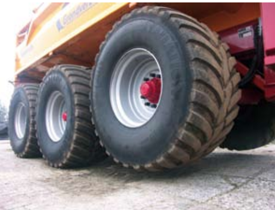
De combinatie staat op de nieuwe Vredestein 750/60R30.5 Flotation Trac met 8,2 ton draagvermogen bij 65 km/u. Ze houden zich tot dusver in de hiel en qua slijtagebestendigheid goed.
