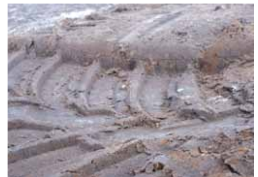
Naast elkaar van links naar rechts de sporen van de Michelin, Alliance en Vredestein nadat vol weer was gepoogd vooruit te rijden. De Michelin zat te diep. De Alliance spoort zichtbaar meer in dan de Vredestein.
