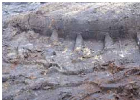
Aan de insporing in zachte, ongespitte zandgrond is te zien dat de Michelin meer inspoort en een steilere oploophoek heeft.
