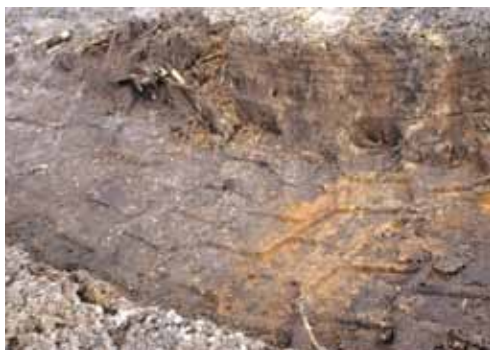
Aan de insporing in zachte, ongespitte zandgrond is te zien dat de Michelin meer inspoort en een steilere oploophoek heeft.
