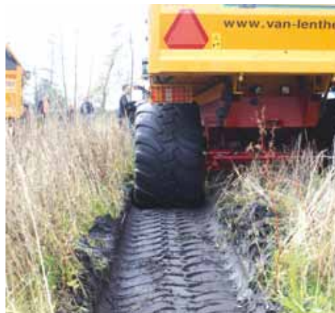
Naast elkaar van links naar rechts de sporen van de Michelin, Alliance en Vredestein nadat vol weer was gepoogd vooruit te rijden. De Michelin zat te diep. De Alliance spoort zichtbaar meer in dan de Vredestein.
